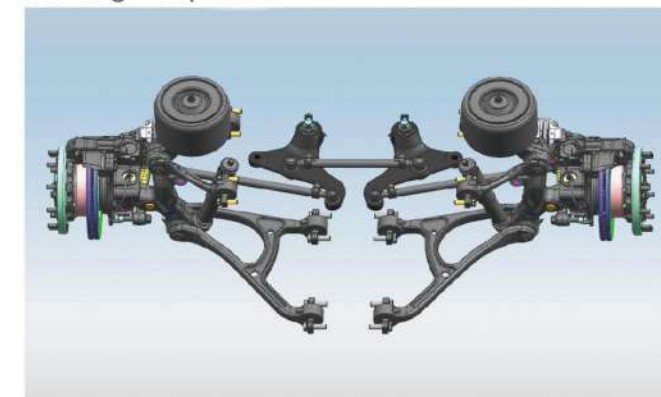
Suspensión delantera y trasera optimizada y tecnología PCV que mejora la amortiguación en carretera en situaciones de conducción complejas.
