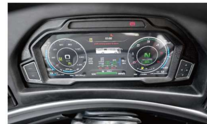
Pantalla LCD Actia de 12,3" a color con capacidades de interacción conductor-bus de rango superior.
